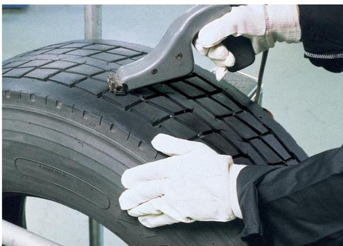
Durante la riscolpitura i profili principali dei pneumatici vengono resi più profondi con l'aiuto di speciali dispositivi mediante estrazione della gomma inferiore. La condizione è di avere sufficiente gomma di base affinché rimangano almeno 2 mm di spessore sopra l'ultimo strato della cintura (supporto).
